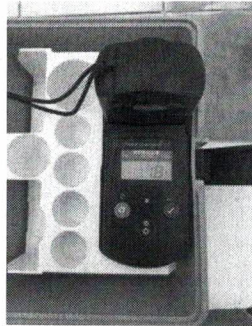
Foto 63 - Análise de cloro realizada durante a fiscalização (1.8 mg/L)
