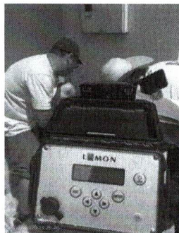
Foto 97 - Pressão: 34,6 m.c.a. Abastecimento pelo reservatório R2. Rua Candido Toston, nº 1132. Número do hidrômetro: Y11C046676
