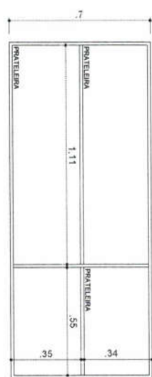
VISTA FRONTAL - interna
